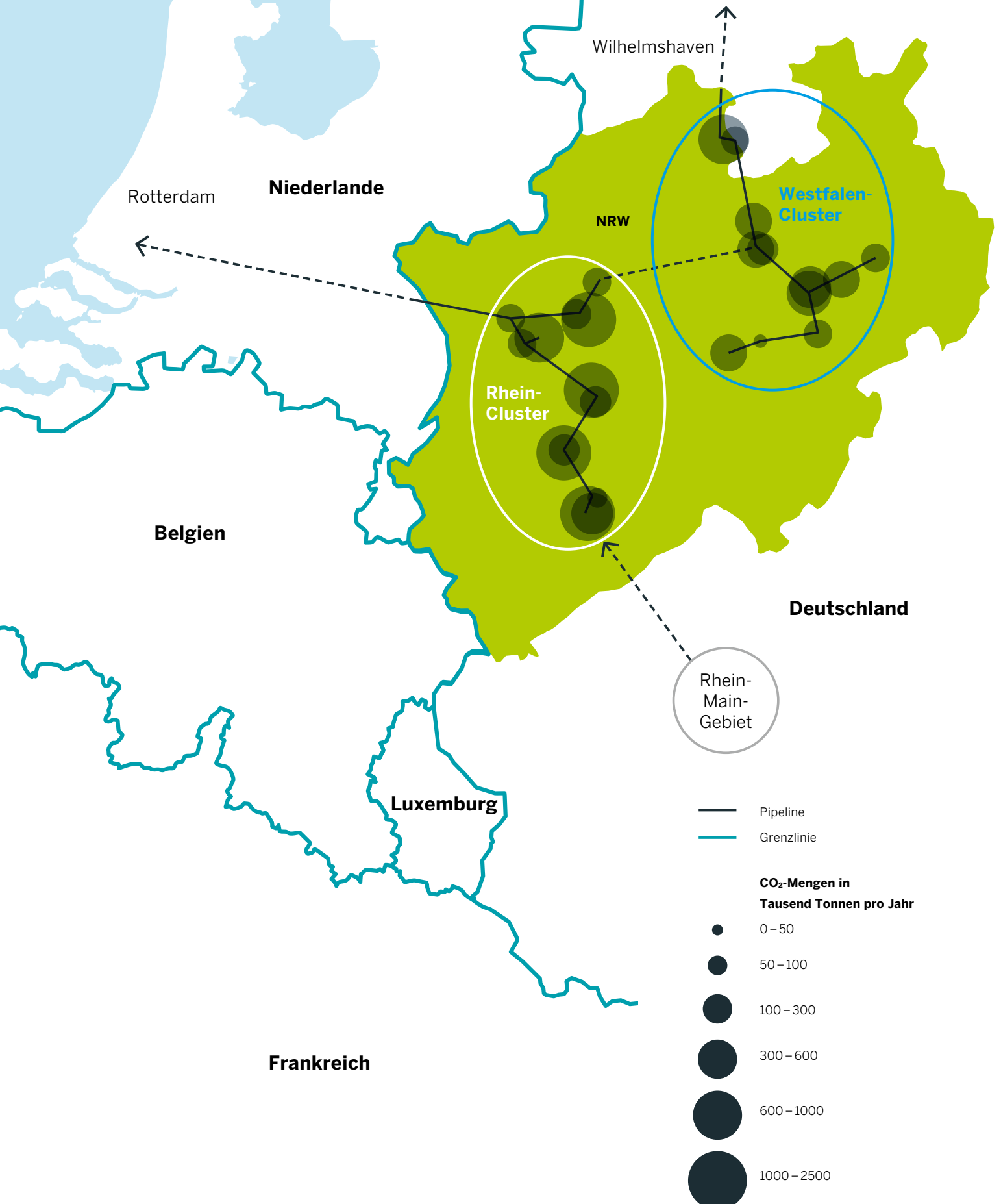
Abbildung 8: Schematischer CO 2 -Pipelineinfrastruktur-Entwurf für das Rhein- und Westfalen-Cluster in einer klimaneutralen Industrie in Nordrhein-Westfalen 86
